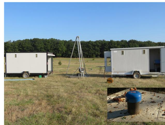
Les deux laboratoires mobiles et le trépied qui permet de faire descendre les sondes de diagraphies destinées au recueil des paramètres physiques via les forages.
